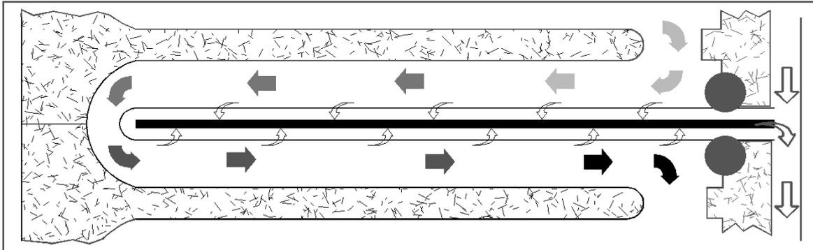
上图放大部分显示了进料液流经过膜片，透过液透过膜片，被膜片中导流布带入透过液通道。导流盘上的O型圈防止进料液进入透过液通道
