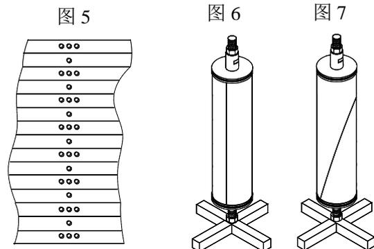
如果板被扭曲,则导流盘上的定位点会断裂。
