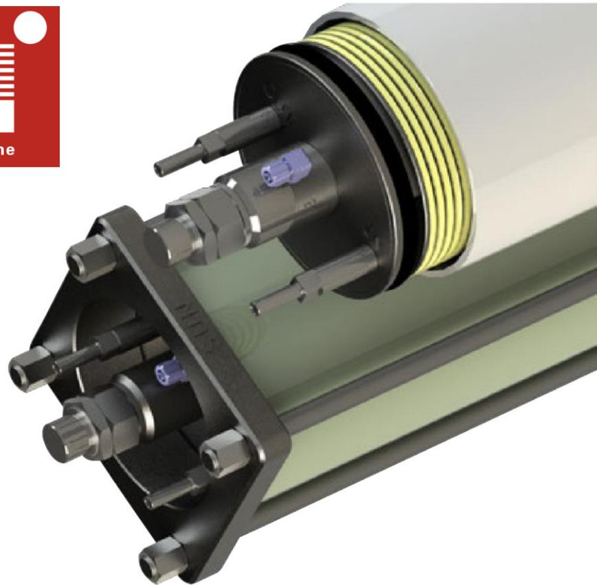
**\*\*为防止储存和运输过程中紧固厚螺母松动, 在新膜使用前, 需用扭力扳手在 110NM 力矩下拧紧紧固厚螺母; 建议使用后每月再检查拧紧一次。**
