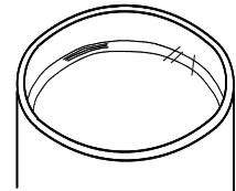
检查唇形密封件的表面接触边缘是否有划痕和磨损, 如果有, 更换新的密封件。唇形密封件, 部件编号: 6
